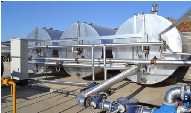
Horizontal bitumen tanks, thermal oil heated Serbatoi orizzontali per bitume, riscaldati ad olio diatermico
