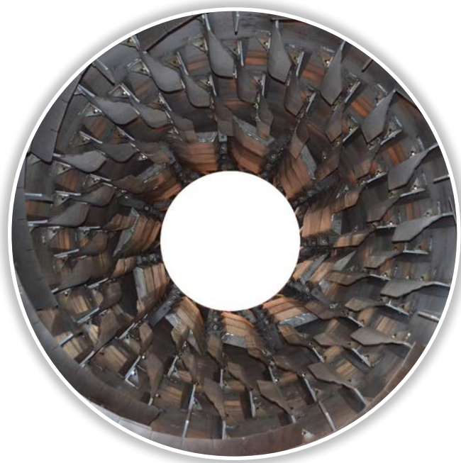
Efficient blade design in bolted construction for optimum drying Design efficiente nella costruzione delle pale imbullonate per un'essiccazione ottimale
