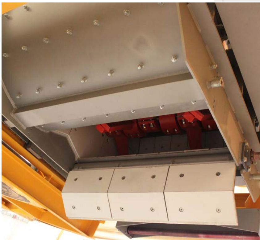
Full width linear opening discharge gate Saracinesca di scarico ad apertura lineare per tutta la larghezza
