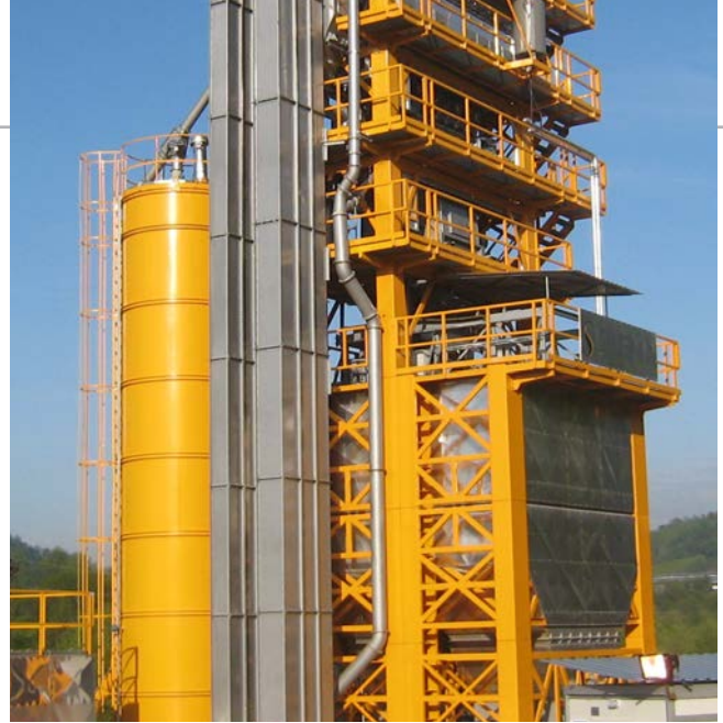
Twin Hot Mix Silo with 170 tons capacity Doppio Silo prodotto finito con capacità di 170 tonnellate
