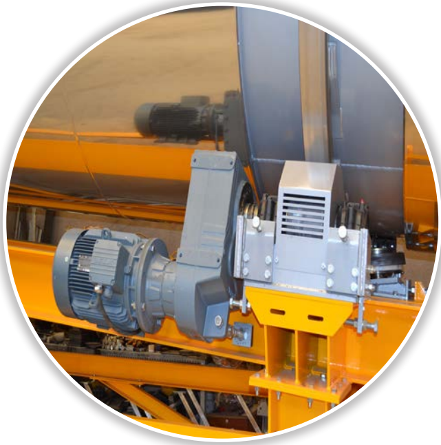
Drive rollers adjustable in two axes Rulli di traino regolabili su due assi
