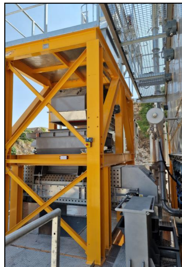
Dosaggio del fresato/ Recycling dosing
